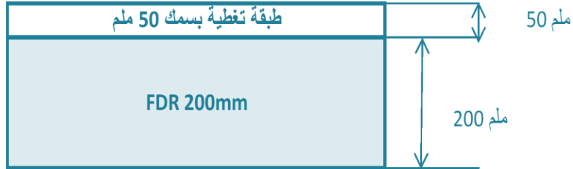
الشكل (8) القطاع النموذجي للطريق [2].
