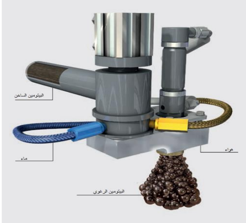
الشكل (3) عملية إنتاج البيتومين الرغوي [5] .
