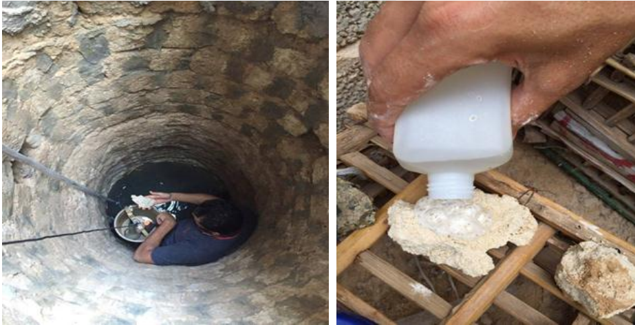
شكل رقم (3): طريقة جمع العينة الجيولوجية من البئر، واختبار العينة بواسطة حمض الهيدروكلوريك المخفف لتعيين نوع الصخر.
